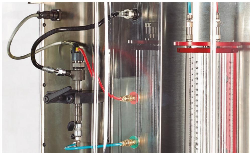
El diseño moderno del banco de pruebas permite al especialista verificar eficazmente cualquier inyector Common Rail de todas las marcas, incluyendo los sistemas piezoeléctricos.
